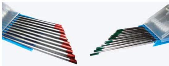
Punta verde: para aluminio Punta roja: para inoxidable Punta dorada: todas las aplicaciones
